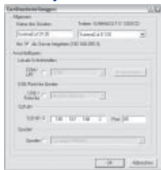
Abb 2: Netzwerk-, Server-, Spooler-Option Die Plot-Server-Option zeigt die lokale IP Adresse, die als TCP/IP-Adresse bei den Clients als Adresse eingetragen werden muss.
